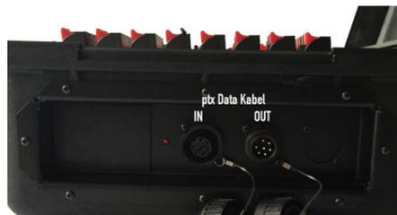
Das ptx system ist ein bidirektionales System. Mit einem ptx Controller können alle Ausgänge programmiert, getestet und gezündet werden (s. Bedienungsanleitungen ptx Controller).
